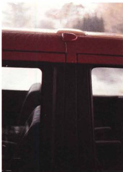
L'antenna del ricevitore satellitare GPS è generalmente piatta e di dimensioni molto ridotte. Alcuni installatori riescono a verniciarle dello stesso colore della carrozzeria senza comprometterne la ricezione (che tuttavia può risentirne se la vernice è metallizzata).
